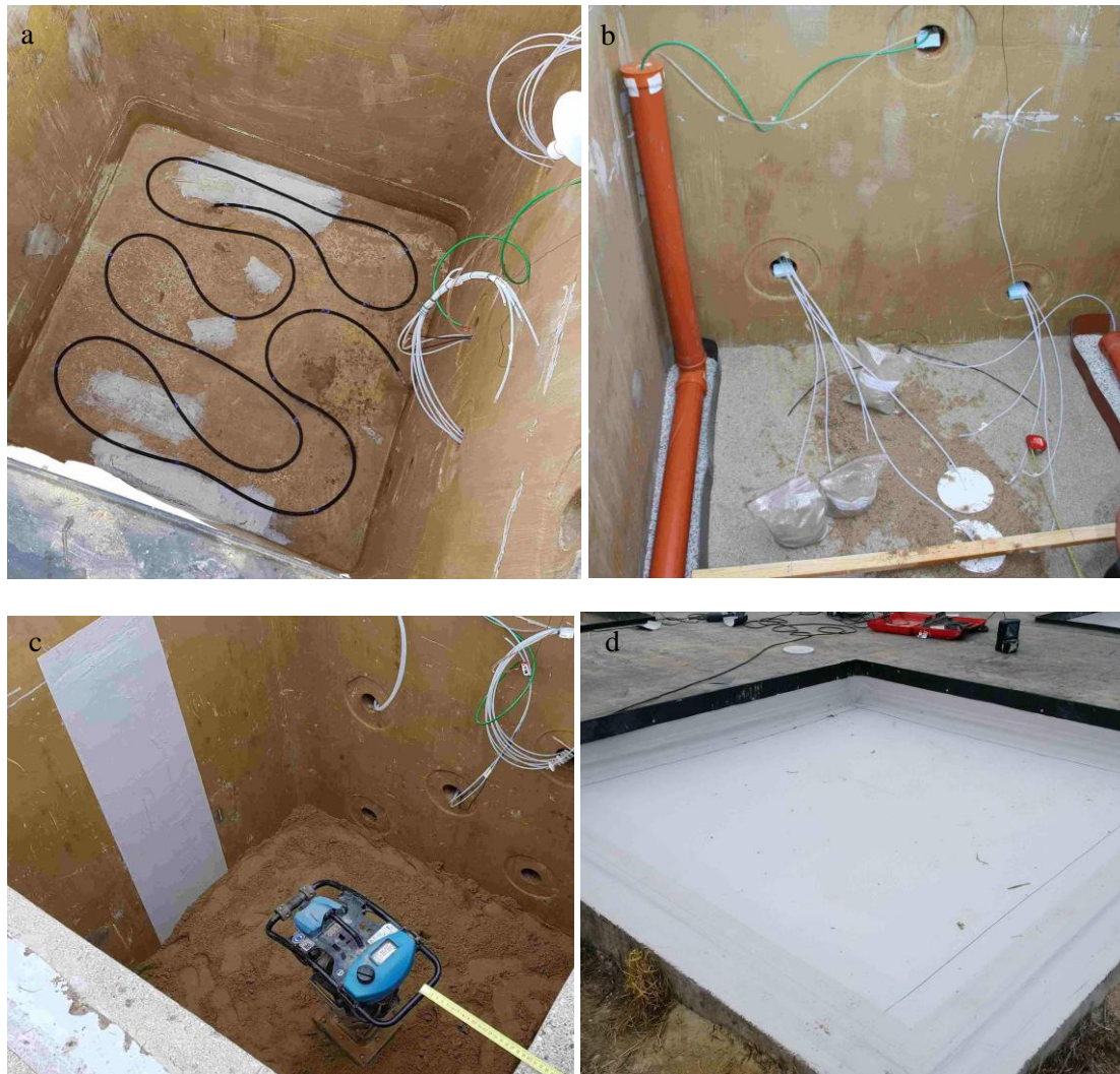
Abbildung 59: Positionierung eines porösen Schlauches am Boden der Lysimeterkammern zur Einbringung von Stickstoff und Wasser bei der Erstbefüllung (a), Probennahmeschläuche und perforierte Zu- und Abflussrohre (b) Verdichten des Sandes 0/4 mm beim Einbau (c), Abdichtung der Kammern an der Oberfläche mittels Folie (d)
