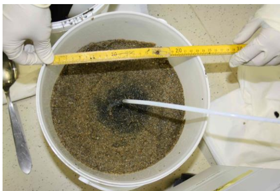
Abbildung 40: Injektion von Nanofer Star Partikeln
