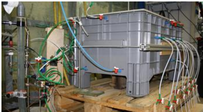
Abbildung 50: Lysimetervorversuch zur Ermittlung der PCE – Eisenpartikelanordnung mit kontinuierlichem Fluss unter kontrolliert anaeroben Bedingungen (a: Profilansicht der Befüllung, b: Grundriss mit Lage des PCE-Herds und der Eisenpartikel)
