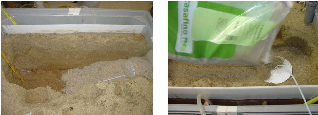
Abbildung 41: Einbringung der Injektionsleitungen in den Aquifer
