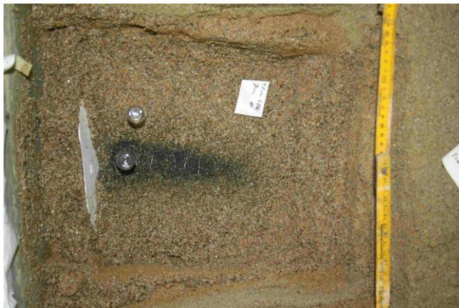
Abbildung 45: Probenahme „Flakes“ Partikel nach horizontaler Injektion sowie 3D Skizze der Partikelausbreitung von „Flakes“ Partikeln (Injektion von 10 l Eisensuspension (3,5 g/l) mit mehreren Packern)
