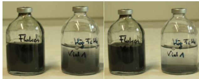
Abbildung 3: Vergleich der Absinkgeschwindigkeit unterschiedlicher Eisenpartikel (Links: Ironflakes, Rechts: Höganäs FeH 4 ) innerhalb von 30 Sekunden
