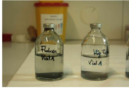
Abbildung 2: Reaktionsgefäße der Batchversuche zum CKW-Abbau mit Eisenpartikeln (Ironflakes und Höganäs FeH 4 )
